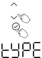
Lorsque l'unité est éteinte, dans la fonction d'interrogation de la température, appuyez sur « V » ou « Λ » pour sélectionner le type. Appuyez sur Confirmer pour accéder au réglage, appuyez sur « V » ou « Λ » pour sélectionner le type, puis appuyez sur Confirmer pour terminer.
