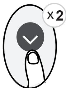
En utilisant cette fonction, l'unité fonctionnera avec une vitesse de ventilation élevée (pendant que le compresseur est en marche) et la température sera automatiquement réglée au niveau le plus bas, 8°C (46°F), afin d'obtenir une climatisation plus efficace.
