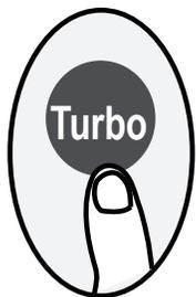
Lorsque vous appuyez sur le bouton TURBO alors que l'unité est en mode COOL, l'unité soufflera de l'air frais avec le réglage de ventilateur le plus élevé pour accélérer le processus de climatisation.
