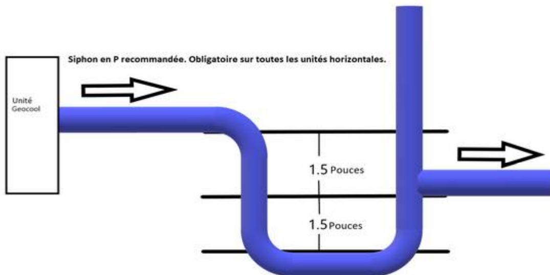
**Ne jamais raccorder l'évacuation de condensat et la conduite d'évacuation d'eau en raison du potentiel de dégâts des eaux importants.**
