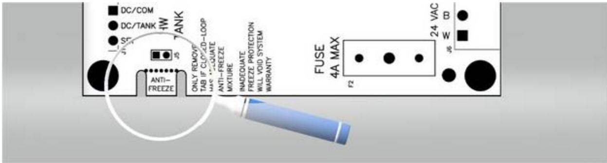
**IMPORTANT !!! Une fois la languette retirée, l'appareil sera réglé en permanence sur 20 degrés et ne pourra plus être modifié !! Le retrait de l'onglet sur les systèmes à boucle ouverte ou les systèmes à boucle fermée sans protection minimale contre le gel annulera toute garantie sur l'unité !**
