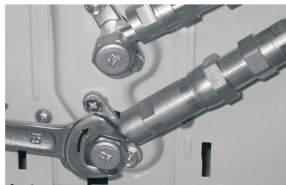
7. Après avoir terminé les étapes 1 à 6, vérifiez que tous les raccords sont correctement scellés à l'aide d'un spray de détection de fuites ou de mousse de savon. Si des bulles se forment, le système présente une fuite et les raccords à vis doivent être resserrés à l'aide d'une clé à molette ou réglable.
