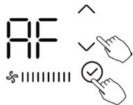
4. Lorsque l'unité est éteinte, dans la fonction d'interrogation de la température, appuyez sur « V » ou « Λ » pour sélectionner AF, puis appuyez sur Confirmer pour passer en mode de test. Appuyez sur « Retour », « Marche/Arrêt » ou « Confirmer » pour quitter le mode de test. En mode AF, le test prend fin au bout de 3 à 6 minutes et se termine automatiquement. Si le test est en cours, appuyez sur « Retour », « Marche/Arrêt » ou « Confirmer » pour l'interrompre et le quitter.
