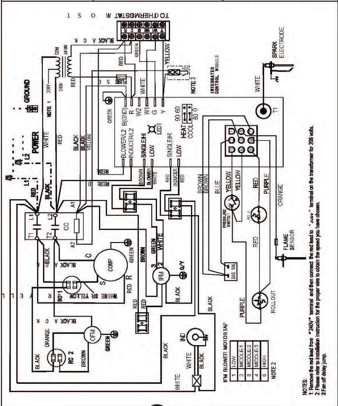
Wiring Diagram (For WRB60S130GWN1-M14)
