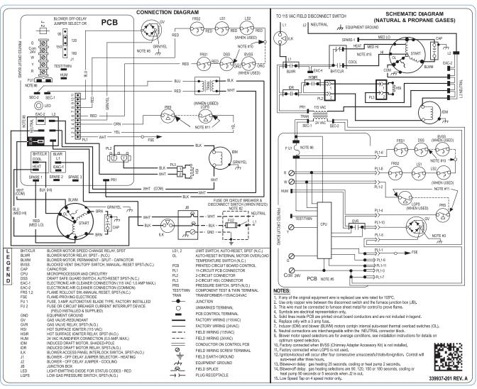
Fig. 41 - Wiring Diagram
